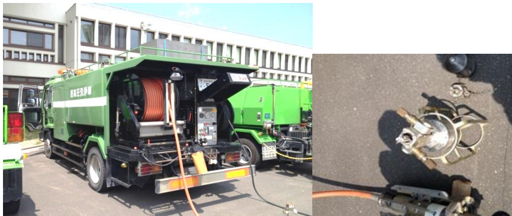
写真 3-11 超高圧洗浄車とターボノズル
