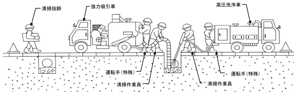
図 4-4 雨水ます清掃工の作業標準図
