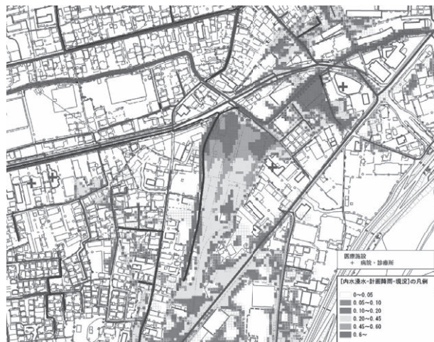
図-3 情報の重ね合わせ例 (公共下水道管路、浸水シミュレーション、医療施設)
